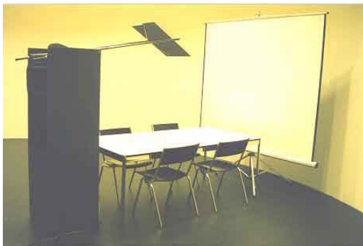
Abbildung 2: BUILD-IT System mit Spiegel, Tisch und Leinwand
